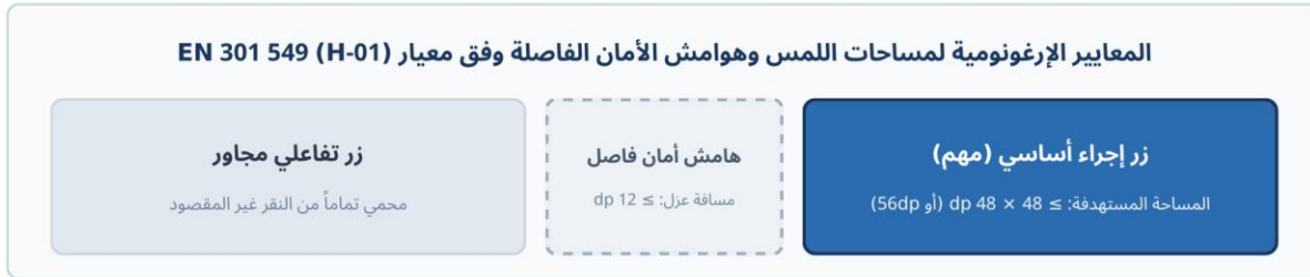
شكل 1: المعايير الإرغونومية لمساحات اللمس وهوامش الأمان الفاصلة وفق معيار EN 301 549 (H-01)
